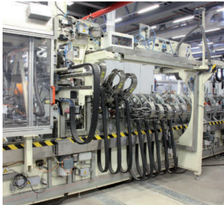
Mit der Investition in automatisch rüstende Kaschiermaschinen stellt Schüco bei wachsender Farbvielfalt und steigendem Farbanteil kurze Lieferzeiten sicher.
