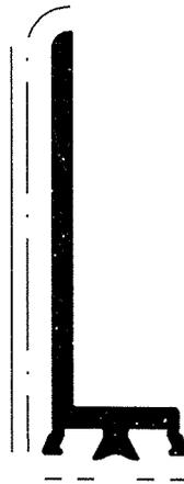
ACHTUNG: Nutenbereich (----) von Farbe, insbesondere von Farbspritzern und Verdickungen freihalten. Nicht vermeidbarer Lackauftrag im Nutenbereich maximal 20µm.
