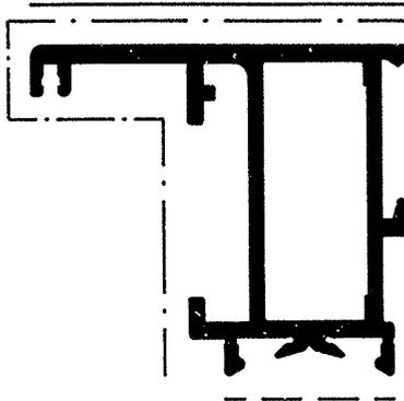
ACHTUNG: NUTENBEREICH (----) VON FARBE, INSBESONDERE VON FARBSPRITZERN UND VERDICKUNGEN FREIHALTEN. NICHT VERMEIDBARER LACKAUFTRAG IM NUTENBEREICH MAXIMAL 20µm
