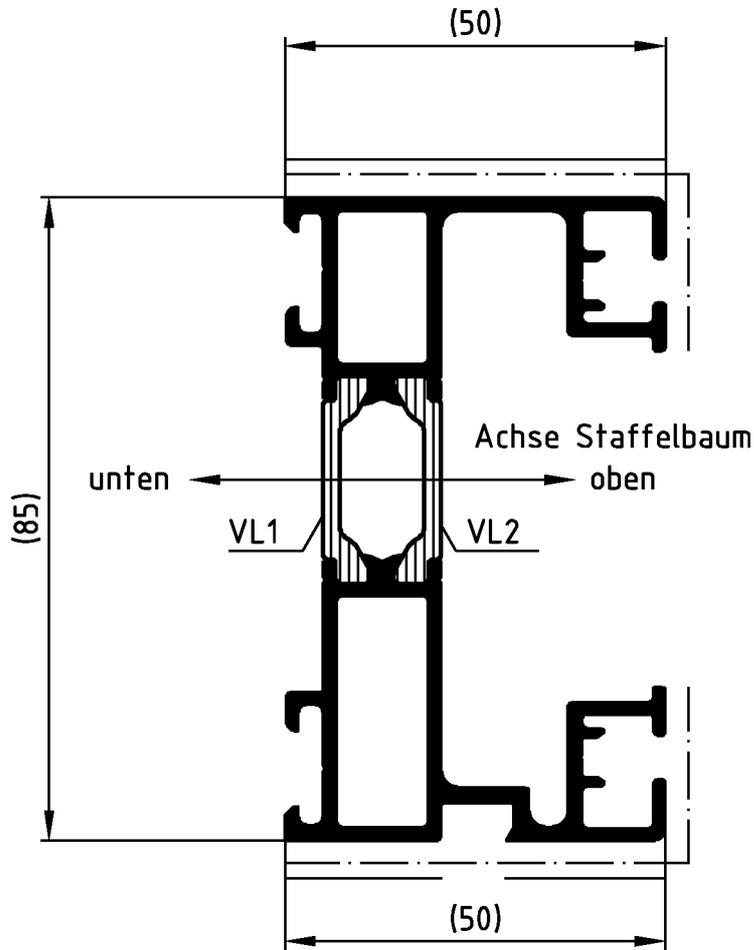
Die Profile sind generell in beiden Aluminium-Hohlkammern spannungsfrei aufzustaffeln.
