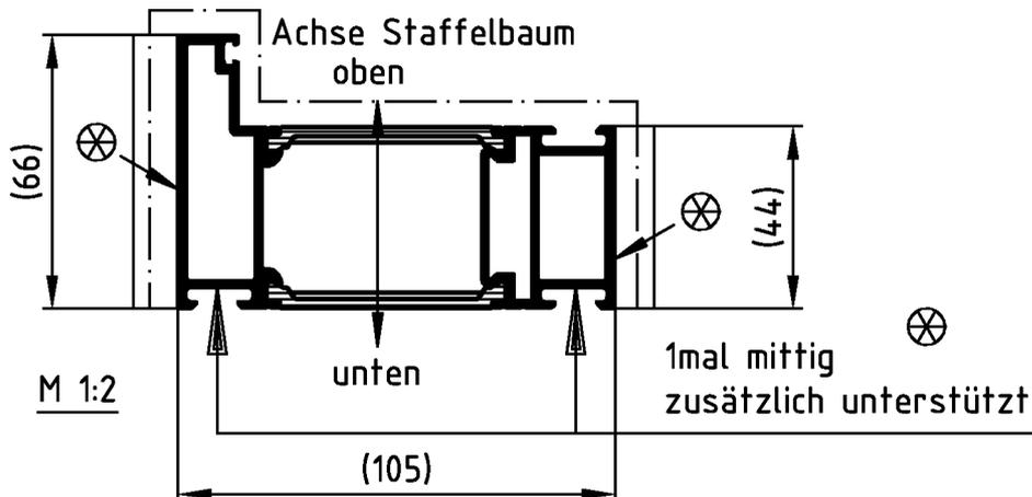
⊗ Durch ausreichenden Abstand der Profil-Sichtflächen zum mittleren Staffelbaum ist die geforderte Mindest-Schichtdicke zu gewährleisten.
