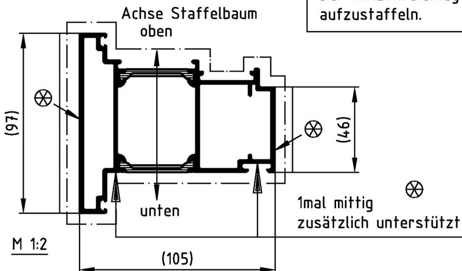
⊗ Durch ausreichenden Abstand der Profil-Sichtflächen zum mittleren Staffelbaum ist die geforderte Mindest-Schichtdicke zu gewährleisten.
