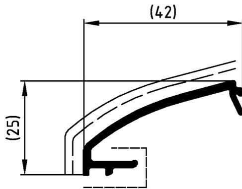
**ACHTUNG:** Bereich (----) von Farbe, insbesondere von Farbspritzern und Verdickungen freihalten. Nicht vermeidbarer Lackauftrag im Nutenbereich maximal 20µm.
