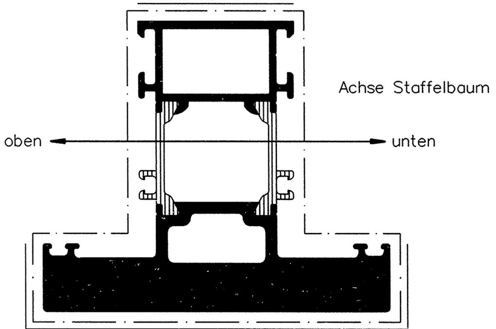
"Beim Aufstaffeln muss das Profil aufgrund des Profildgewichtes in beiden Hohlkammern aufgenommen werden"
