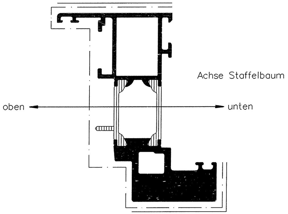
"Beim Aufstaffeln muss das Profil aufgrund des Profildgewichtes in beiden Hohlkammern aufgenommen werden"
