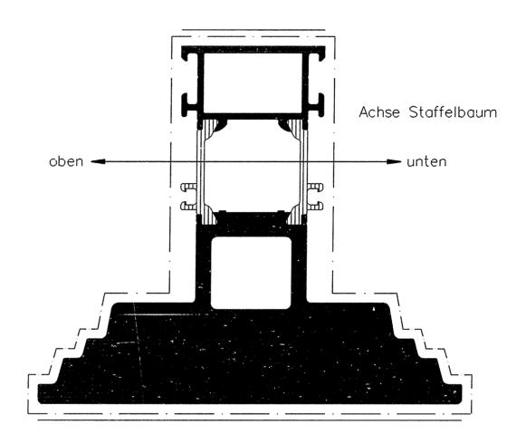
"Beim Aufstaffeln muss das Profil aufgrund des Profilgewichtes in beiden Hohlkammern aufgenommen werden"
