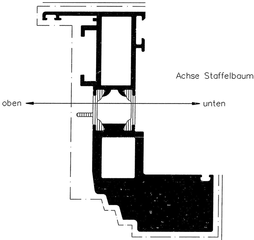
"Beim Aufstaffeln muss das Profil aufgrund des Profilgewichtes in beiden Hohlkammern aufgenommen werden"
