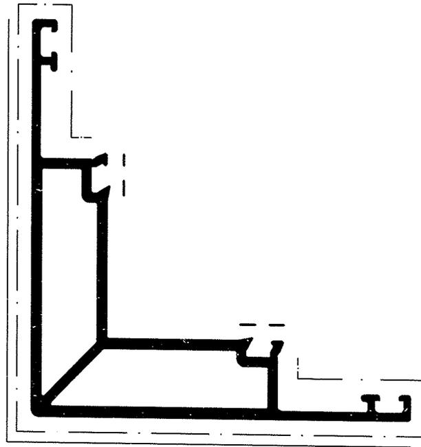
ACHTUNG: Nutenbereich (----) von Farbe, insbesondere von Farbspritzern und Verdickungen freihalten. Nicht vermeidbarer Lackauftrag im Nutenbereich maximal 20µm.
