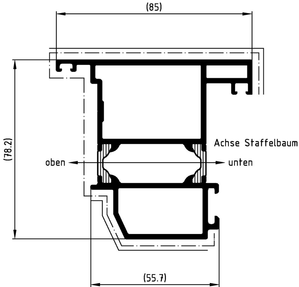
Die Profile sind generell in beiden Aluminium-Hohlkammern spannungsfrei aufzustaffeln.
