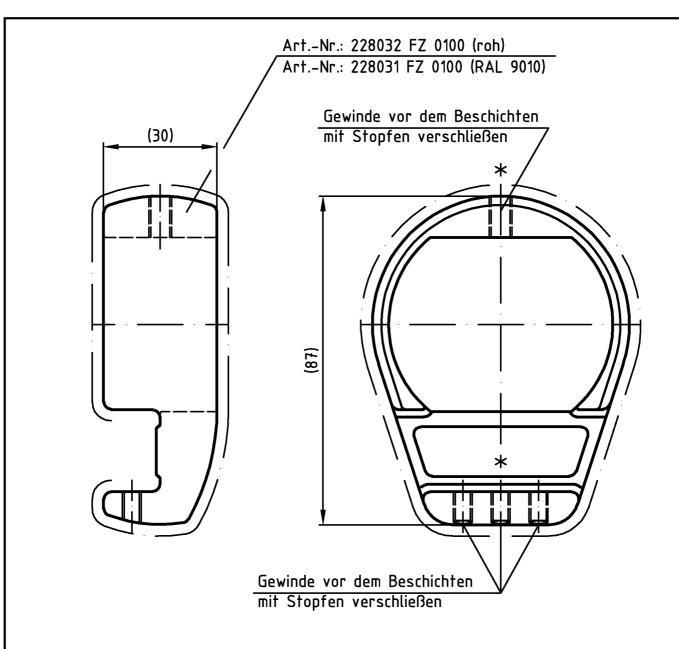
\* mittigen Gew.-Stift M5x8 und Gew.-Stift M6x12 nach dem Beschichten einschrauben zusätzliches Verbindungsmaterial wieder hinzufügen
