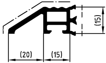
ACHTUNG: Nutenbereich (----) von Farbe, insbesondere von Farbspritzern und Verdickungen freihalten. Nicht vermeidbarer Lackauftrag im Nutenbereich maximal 20µm.
