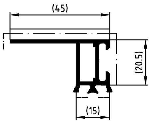
**ACHTUNG:** Nutenbereich (----) von Farbe, insbesondere von Farbspritzern und Verdickungen freihalten. Nicht vermeidbarer Lackauftrag im Nutenbereich maximal 20 µm.
