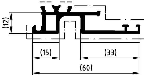
**ACHTUNG:** Nutenbereich (----) von Farbe, insbesondere von Farbspritzern und Verdickungen freihalten. Nicht vermeidbarer Lackauftrag im Nutenbereich maximal 20 µm.
