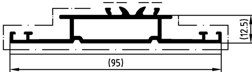
**ACHTUNG:** Nutenbereich (----) von Farbe, insbesondere von Farbspritzern und Verdickungen freihalten. Nicht vermeidbarer Lackauftrag im Nutenbereich maximal 20 µm.
