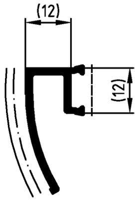
**ACHTUNG:** Nutenbereich (----) von Farbe, insbesondere von Farbspritzern und Verdickungen freihalten. Nicht vermeidbarer Lackauftrag im Nutenbereich maximal 20 µm.
