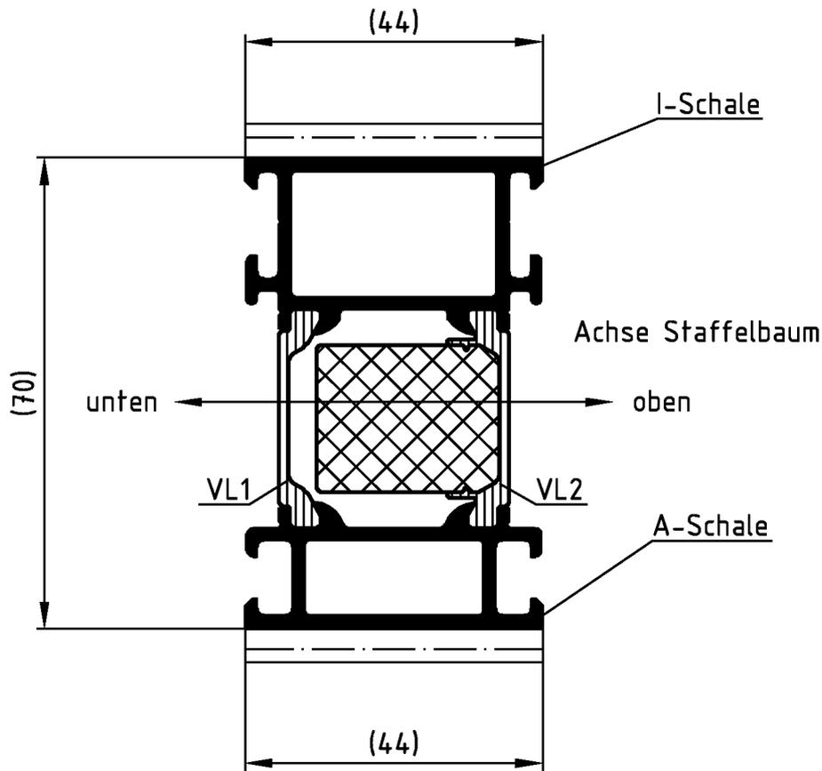
Profile vorzugsweise in einer Vertikalanlage beschichten.
