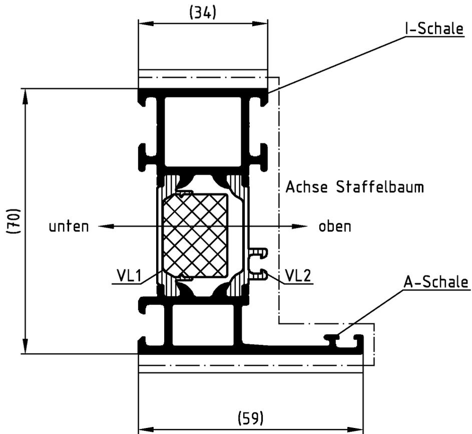
Profile vorzugsweise in einer Vertikalanlage beschichten.
