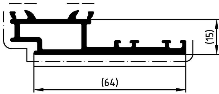
**ACHTUNG:** Nutenbereich (----) von Farbe, insbesondere von Farbspritzern und Verdickungen freihalten. Nicht vermeidbarer Lackauftrag im Nutenbereich maximal 20µm.
