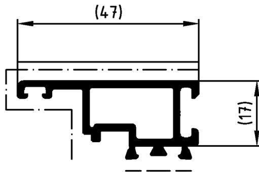
**ACHTUNG:** Nutenbereich (-----) von Farbe, insbesondere von Farbspritzern und Verdickungen freihalten. Nicht vermeidbarer Lackauftrag im Nutenbereich max. 20 µm.
