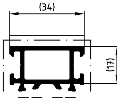
ACHTUNG: Nutenbereich (-----) von Farbe, insbesondere von Farbspritzern und Verdickungen freihalten. Nicht vermeidbarer Lackauftrag im Nutenbereich max. 20 µm.
