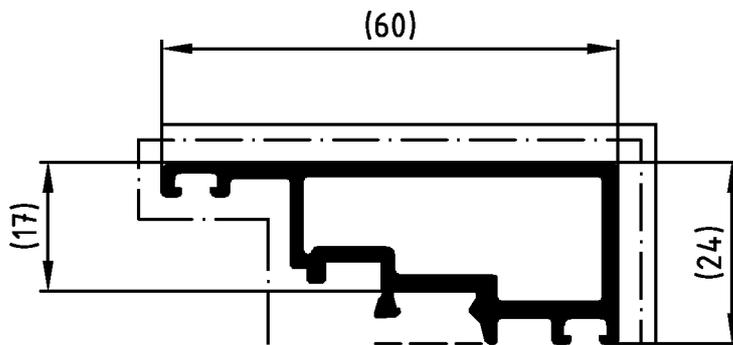
**ACHTUNG:** Nutenbereich (-----) von Farbe, insbesondere von Farbspritzern und Verdickungen freihalten. Nicht vermeidbarer Lackauftrag im Nutenbereich max. 20 µm.
