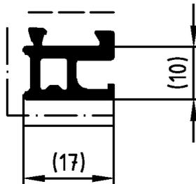
ACHTUNG: Nutenbereich (-----) von Farbe, insbesondere von Farbspritzern und Verdickungen freihalten. Nicht vermeidbarer Lackauftrag im Nutenbereich max. 20 µm.
