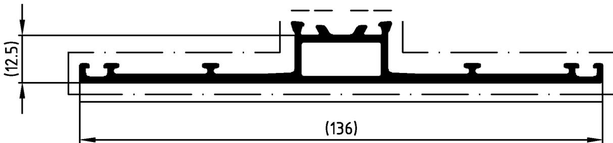
**ACHTUNG:** Nutenbereich (-----) von Farbe, insbesondere von Farbspritzern und Verdickungen freihalten. Nicht vermeidbarer Lackauftrag im Nutenbereich max. 20 µm.
