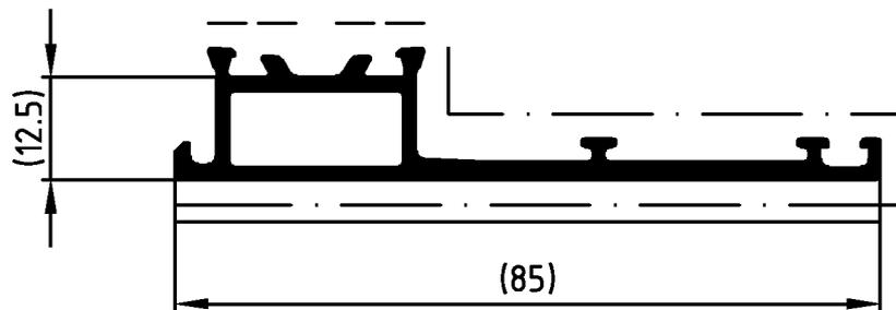
**ACHTUNG:** Nutenbereich (-----) von Farbe, insbesondere von Farbspritzern und Verdickungen freihalten. Nicht vermeidbarer Lackauftrag im Nutenbereich max. 20 µm.
