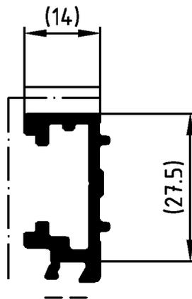
ACHTUNG: Nutenbereich (-----) von Farbe, insbesondere von Farbspritzern und Verdickungen freihalten. Nicht vermeidbarer Lackauftrag im Nutenbereich max. 20 µm.
