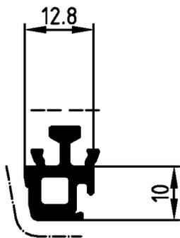
**ACHTUNG:** Nutenbereich (----) von Farbe, insbesondere von Farbspritzern und Verdickungen freihalten. Nicht vermeidbarer Lackauftrag im Nutenbereich maximal 20 µm.
