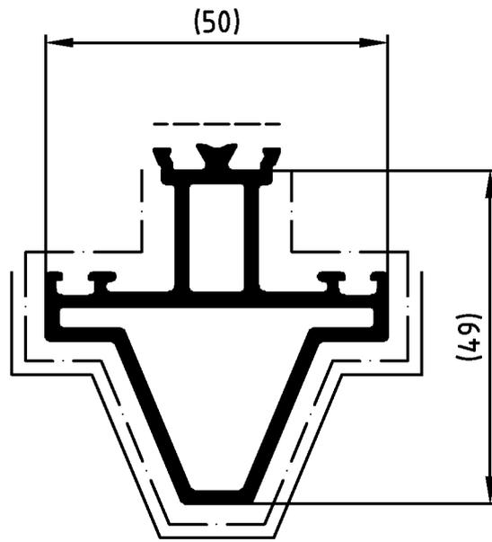
**ACHTUNG:** Nutenbereich (-----) von Farbe, insbesondere von Farbspritzern und Verdickungen freihalten. Nicht vermeidbarer Lackauftrag im Nutenbereich maximal 20 µm.
