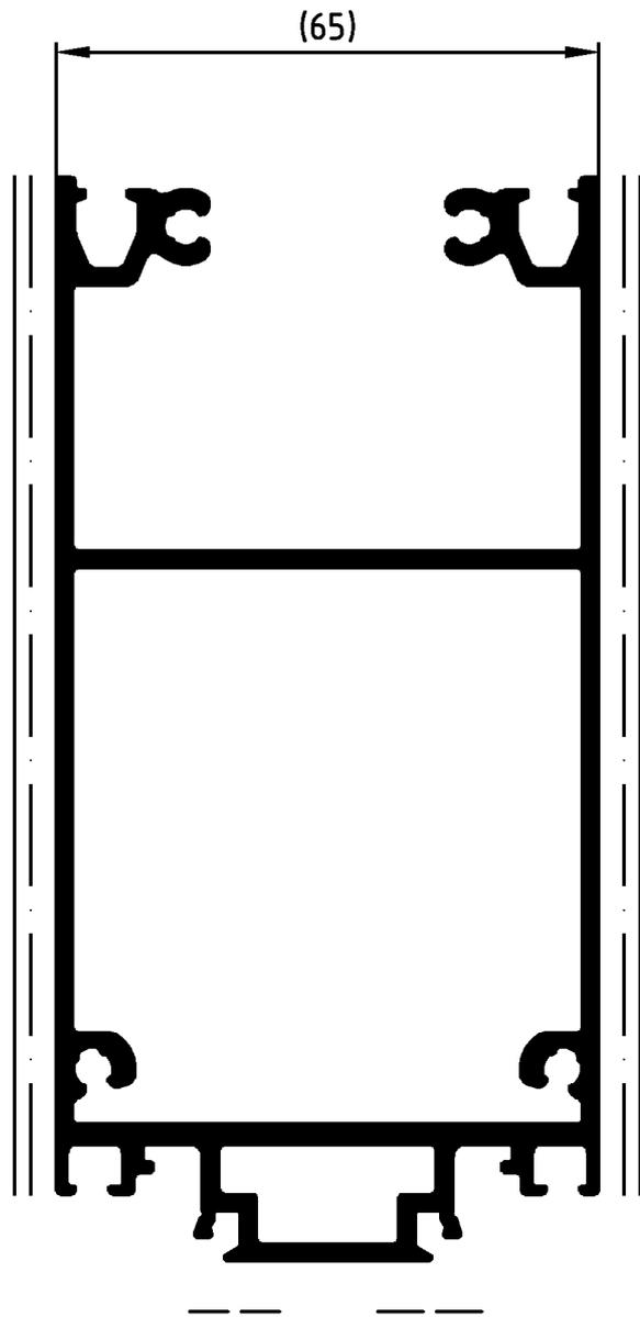
ACHTUNG: Nutenbereich (-----) von Farbe, insbesondere von Farbspritzern und Verdickungen freihalten. Nicht vermeidbarer Lackauftrag im Nutenbereich maximal 20 µm.
