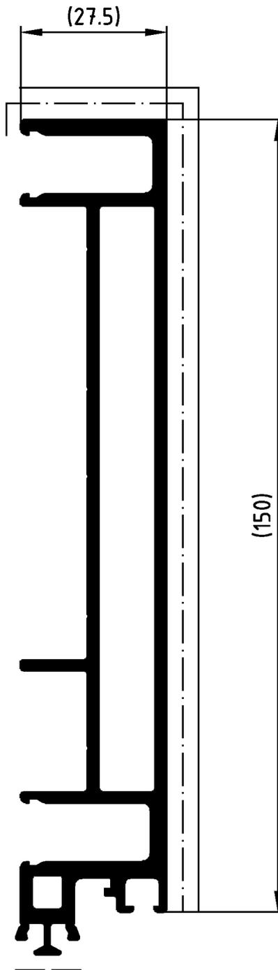
Achtung : Nutenbereich (-----) von Farbe, insbesondere von Farbspritzern und Verdickungen freihalten. Nicht vermeidbarer Lackauftrag im Nutenbereich maximal 20 µm.
