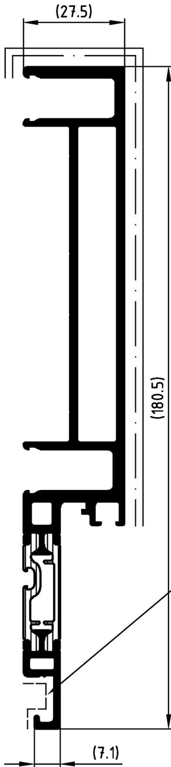
Die Profile sind vertikal hängend und spannungsfrei an der Innenschale aufzustaffeln!
