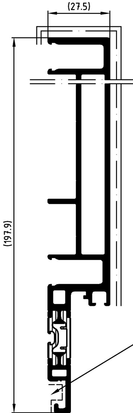
Die Profile sind vertikal hängend und spannungsfrei an der Innenschale aufzustaffeln!
