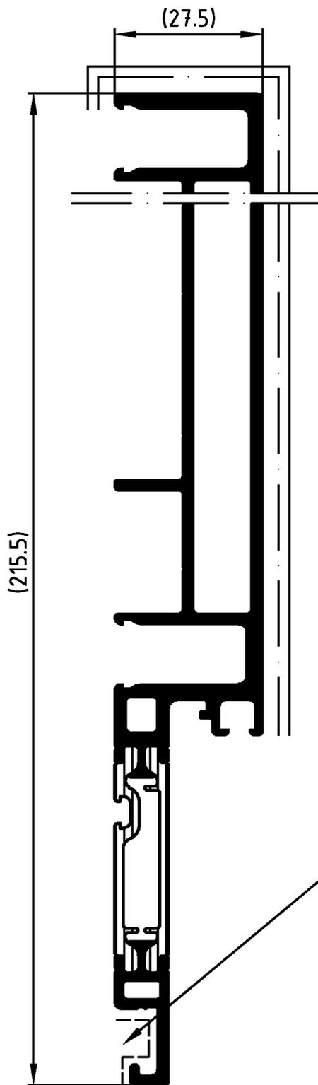
Die Profile sind vertikal hängend und spannungsfrei an der Innenschale aufzustaffeln!
