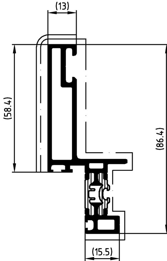
Die Profile sind generell in beiden Aluminium-Hohlkammern spannungsfrei aufzustaffeln.
