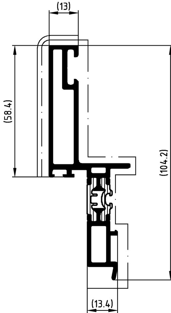
Die Profile sind generell in beiden Aluminium-Hohlkammern spannungsfrei aufzustaffeln.
