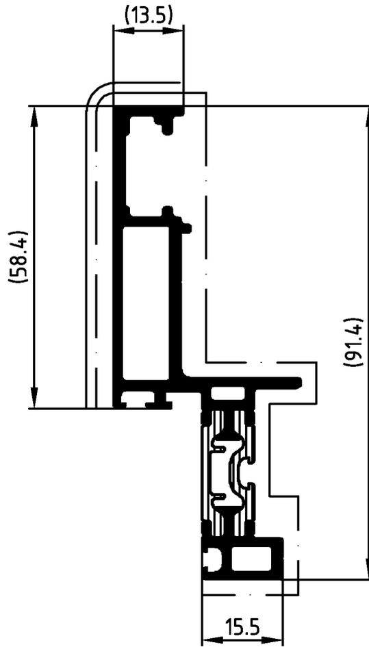
Die Profile sind generell in beiden Aluminium-Hohlkammern spannungsfrei aufzustaffeln.
