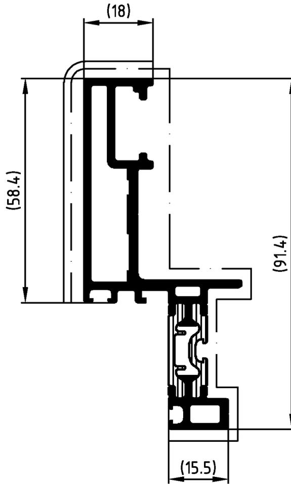
Die Profile sind generell in beiden Aluminium-Hohlkammern spannungsfrei aufzustaffeln.
