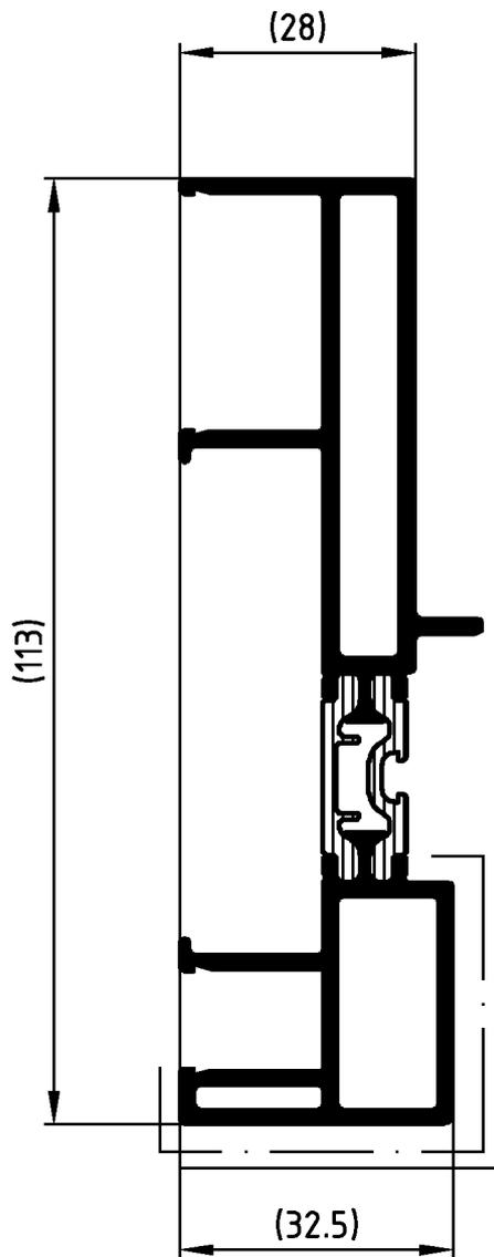
Die Profile sind generell in beiden Aluminium-Hohlkammern spannungsfrei aufzustaffeln.
