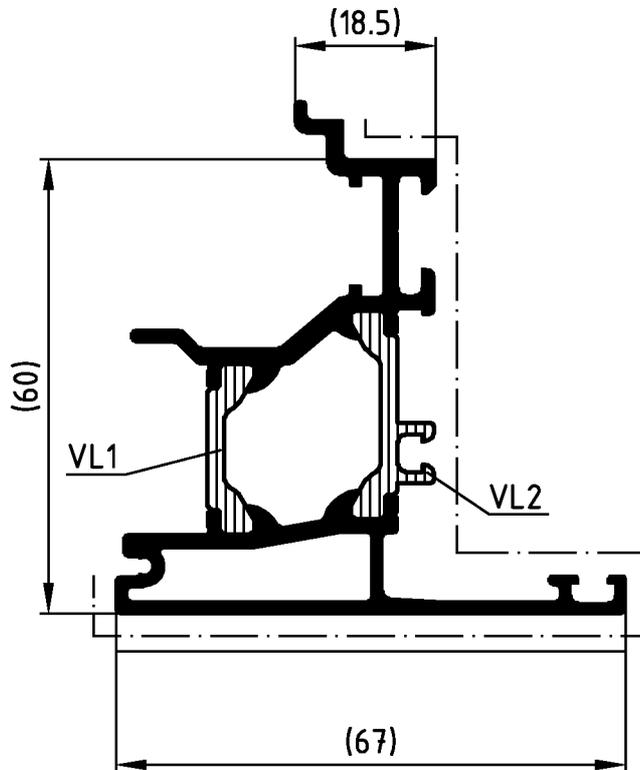
Die Profile sind generell in beiden Aluminium-Hohlkammern spannungsfrei aufzustaffeln.
