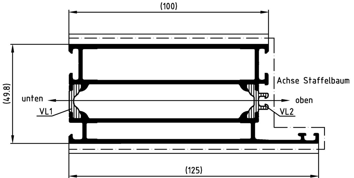
Die Profile sind generell in beiden Aluminium-Hohlkammern spannungsfrei aufzustaffeln.
