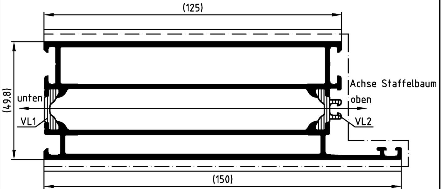
Die Profile sind generell in beiden Aluminium-Hohlkammern spannungsfrei aufzustaffeln.
