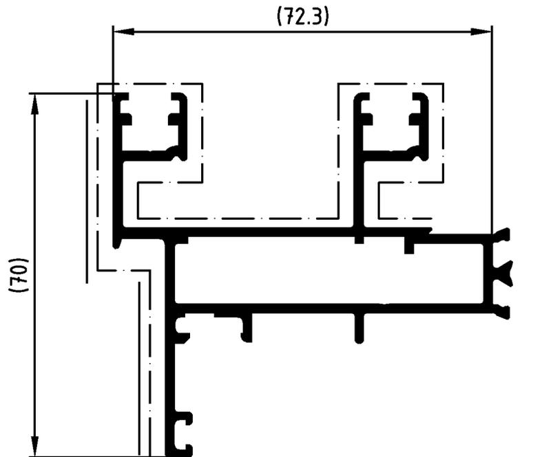
**ACHTUNG:** Nutenbereich (----) von Farbe, insbesondere von Farbspritzern und Verdickungen freihalten. Nicht vermeidbarer Lackauftrag im Nutenbereich maximal 20 µm.
