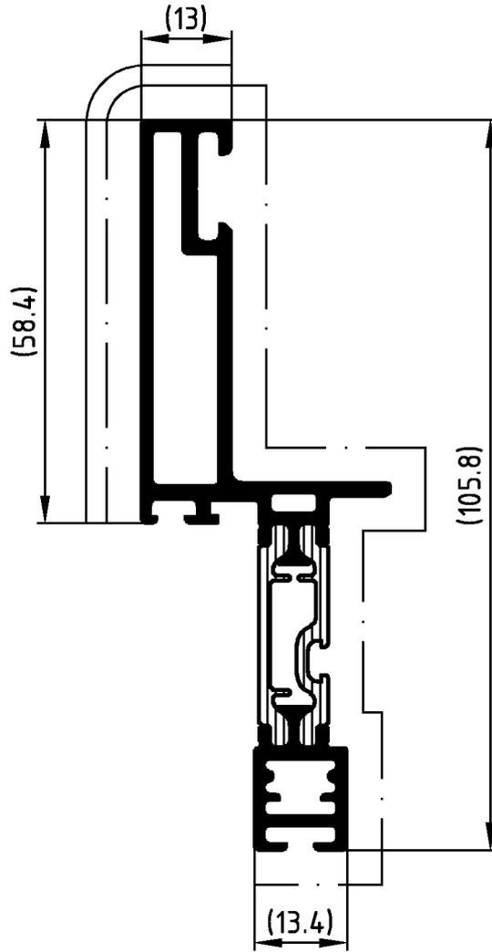
Die Profile sind generell in beiden Aluminium-Hohlkammern spannungsfrei aufzustaffeln.
