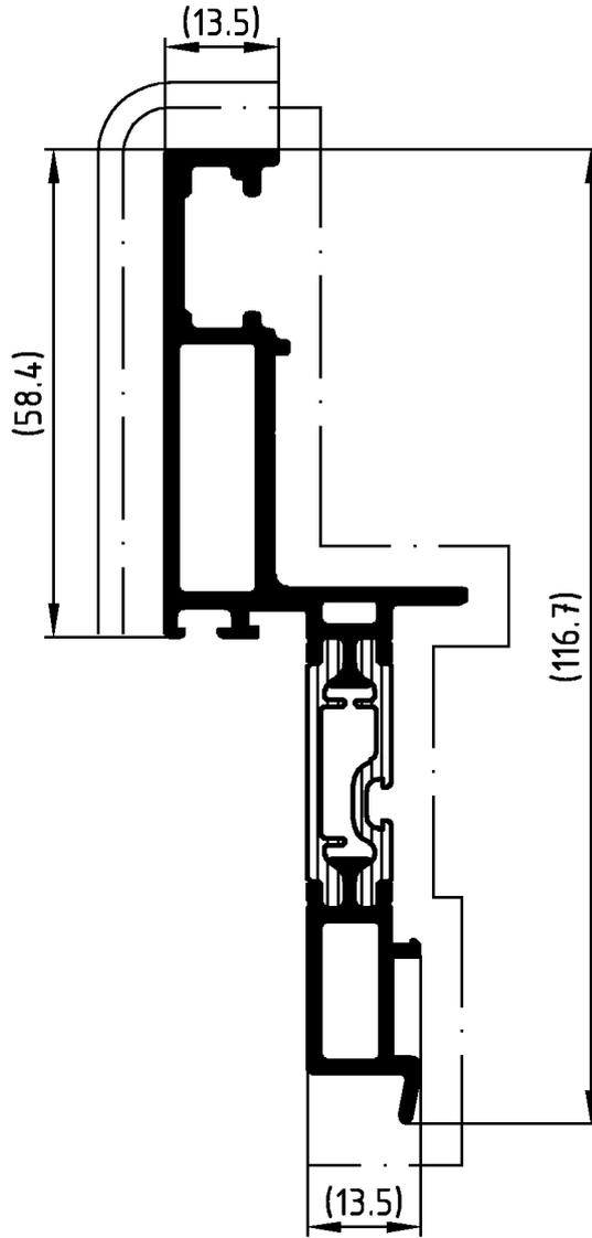
Die Profile sind generell in beiden Aluminium-Hohlkammern spannungsfrei aufzustaffeln.
