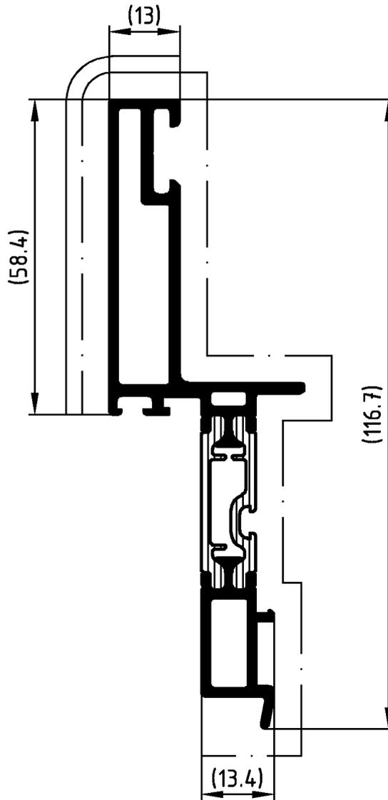
Die Profile sind generell in beiden Aluminium-Hohlkammern spannungsfrei aufzustaffeln.
