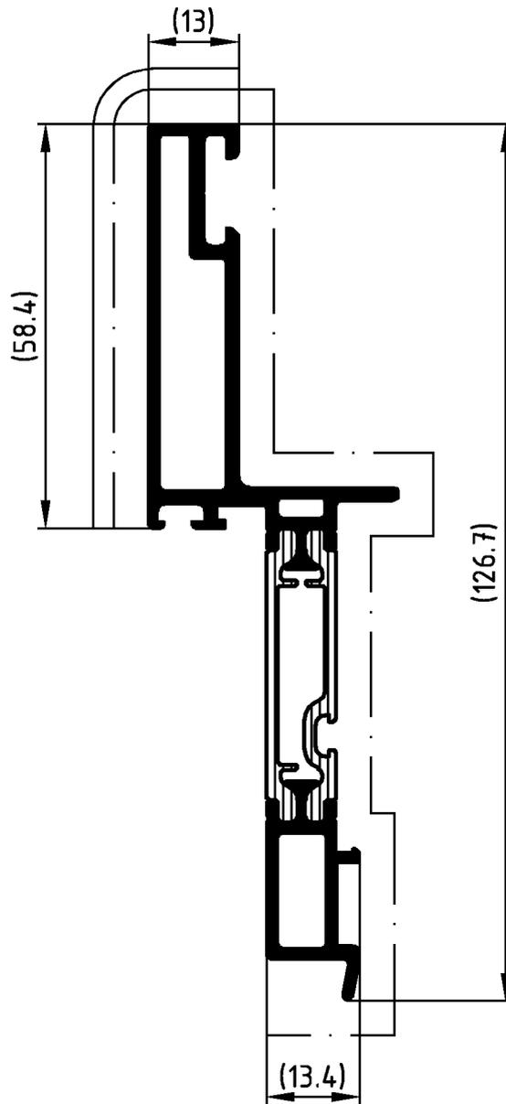
Die Profile sind generell in beiden Aluminium-Hohlkammern spannungsfrei aufzustaffeln.
