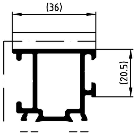
**ACHTUNG:** Nutenbereich (--- --) von Farbe, insbesondere von Farbspritzern und Verdickungen, freihalten. Nicht vermeidbarer Lackauftrag im Nutbereich maximal 20µm.
